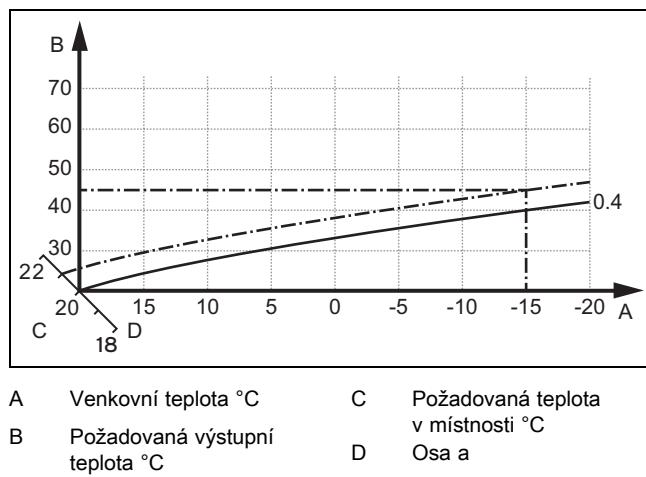
Je-li zvolena topná křivka 0.4 a zadána požadovaná teplota v místnosti 21 °C, topná křivka se posune podle obrázku. Na ose skloněné pod úhlem 45° se topná křivka paralelně posune podle hodnoty požadované teploty místnosti. Při venkovní teplotě -15 °C zajistí regulace výstupní teplotu 45 °C.
