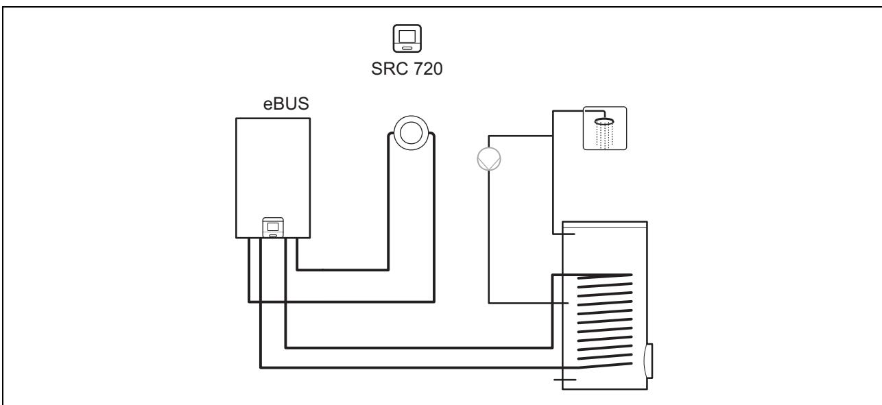
Jednoduché systémy s jedním přímým topným okruhem nevyžadují žádný funkční modul.
