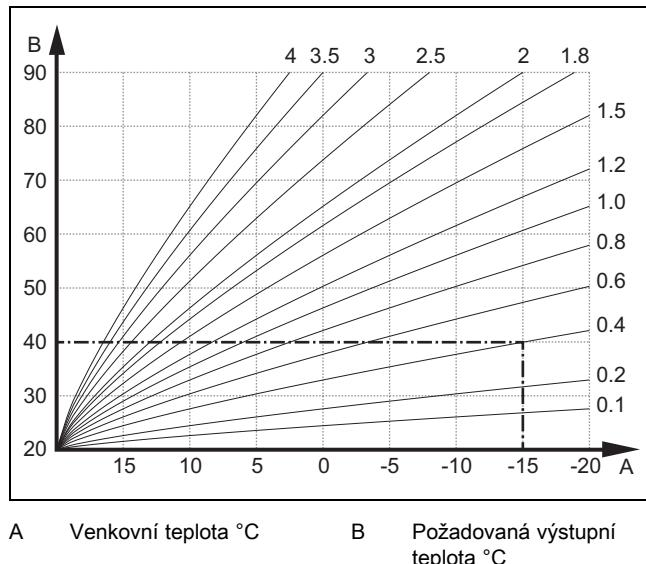
Na obrázku jsou možné topné křivky od 0.1 do 4.0 pro požadovanou teplotu místnosti 20 °C. Pokud se zvolí např. topná křivka 0.4, potom při venkovní teplotě -15 °C bude teplota na výstupu do topení řízena na 40 °C.
