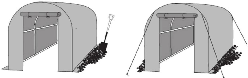
Jak nakonec připevněte provaz pomocí smyček na fólii a pevně připevněte k zemi pomocí dodaných kolíků.
