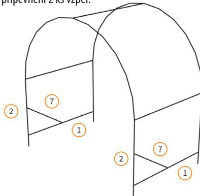
Jeden konec vzpěry (7) připevněte k vertikální dolní tyči (2) a druhý konec k předvrstanému otvoru na dolní přední horizontální tyči (1). Tento krok opakujte a připojte obě vzpěry (7). Nyní jste úspěšně dokončili přední část fóliovníku.
