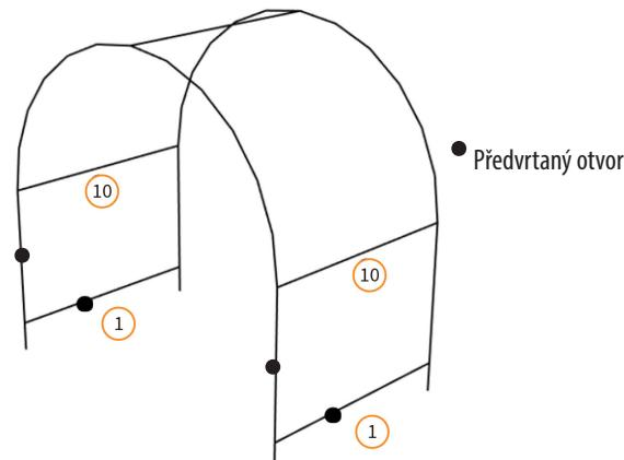
Pro připevnění dolních horizontálních tyčí (1) a přední horizontální tyče (10) musí být tyto umístěny ve vnitřní části fóliovníku. Nejprve připevněte 2x dolní horizontální tyč (1) k přední části; zajistěte, aby předvrstané otvory, umístěné v 1/3 délky každé tyče, byly umístěny blíže k přední části fóliovníku.
