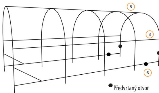
Pro připevnění dolních horizontálních tyčí (zadních) (6) a zadních horizontálních tyčí (8) k dokončené části musí být tyče umístěny na vnitřní straně fóliovníku. Nejprve připevněte 2x dolní horizontální tyč (zadní) (6) k zadní části, aby se zajistilo, že předvrtné otvory, umístěné v 1/3 délky každé tyče, jsou umístěny blíže k zadní části fóliovníku. Dále připevněte 3x zadní horizontální tyč (8) k zadní části fóliovníku...
