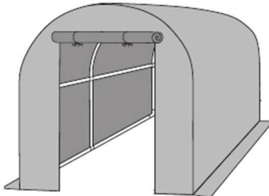
Nakonec před ukotvením provazů (14) doporučujeme přesah plachty zahrnout zeminou případně položit cihly nebo kameny, aby se fóliovník ukotvil dobře do země.
