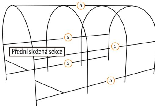
Pro připevnění středních tyčí (5) k dokončeným částem musí být střední tyče (5) umístěny na vnitřní straně fóliovníku.
