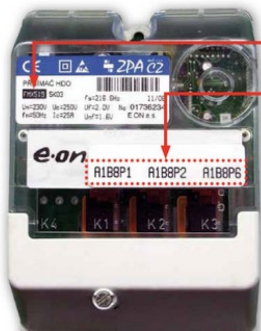
Obrázek 8: Jedna z možností přijímače HDO
