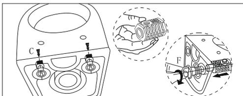
4. Díl C našroubujte na keramiku, pod maticí vložte těsnění E a přitáhněte klíčem F.
