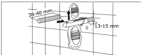
2. Našroubujte trn B na závitovou tyč a nastavte zářez šroubu svisle nahoru. Rozměry se mohou lišit, dle výrobní tolerance keramiky.
