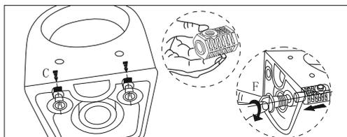
4. Diel C naskrutkujte na keramiky, pod maticu vložte tesnenie E a pritiahnite kľúčom F.
