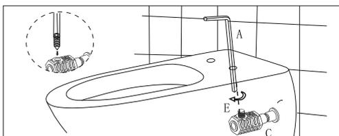
6. Dotáhněte šroub D klíčem A, pro snadnější montáž použijte vodící trubičky. Instalace dokončena. Usadte se pro kontrolu stability.
