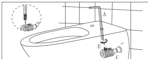
6. Dotiahnite skrutku D kľúčom A, pre jednoduchšie montáž použite vodiace trubičky. inštalácia dokončená. Usadte sa pre kontrolu stability.
