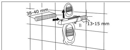
2. Naskrutkujte trň B na závitovú tyč a nastavte zárez skrutky zvisle hore. Rozmery sa môžu líšiť, podľa výrobných tolerancií keramiky.
