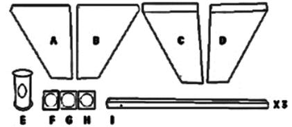
Pokud instalujete externí násypku o velikosti 350kg pelet, pak využijete ke standardní násypce jeden rozšiřovací plech typu B a násypku o něj rozšíříte během instalačního bodu 2. Jinak je instalace totožná s uvedeným postupem.
